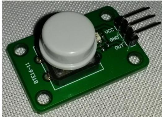
Рисунок 5 – Кнопка с подтягивающим резистором на печатной плате
